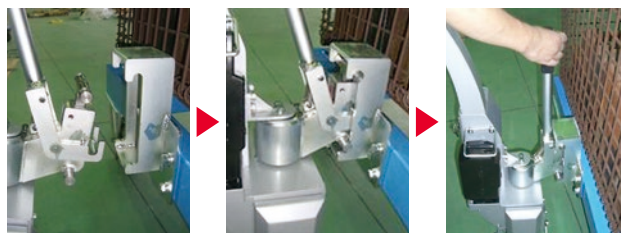
連結ボックスに入れるだけで 外すときはレバーを操作して 連結することができます 連結を解除
