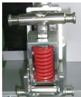
連結部にサスペンション機構を搭載
