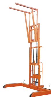
94 ハンドリフト(油圧) ●荷重350kg ●揚程3500mm ●バッテリー式●2段マスト
