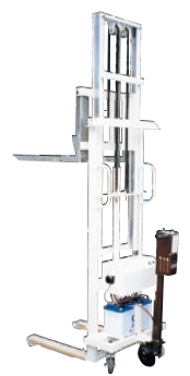
85 ハンドリフト(油圧) ●荷重350kg ●揚程2500mm ●バッテリー式 ●自走タイプ●2段マスト
