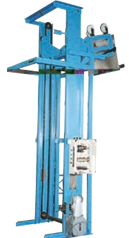
185 インバーションリフト ●ILC ●荷重100kg ●ステン容器着脱式
