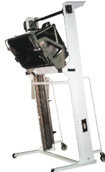
184 インバーションリフト ●ILC ●荷重80kg ●紙ドラム用
